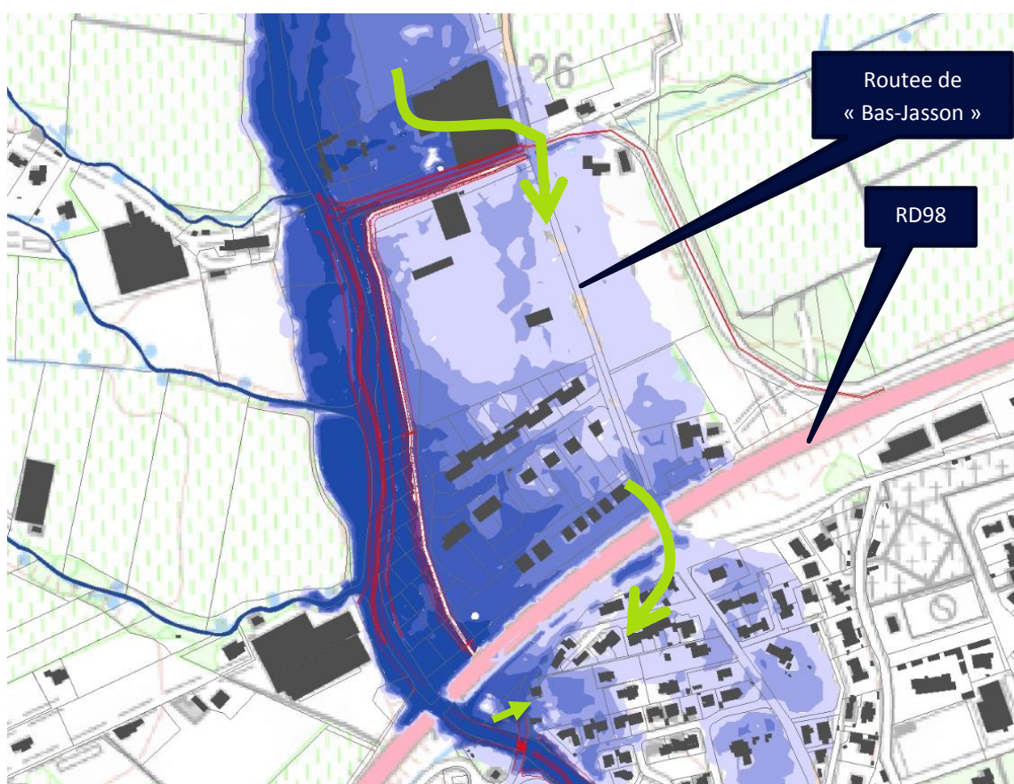
Figure 0-15: Evolution de la crue de sureté sans dysfonctionnement dans la zone protégée de la RD98
